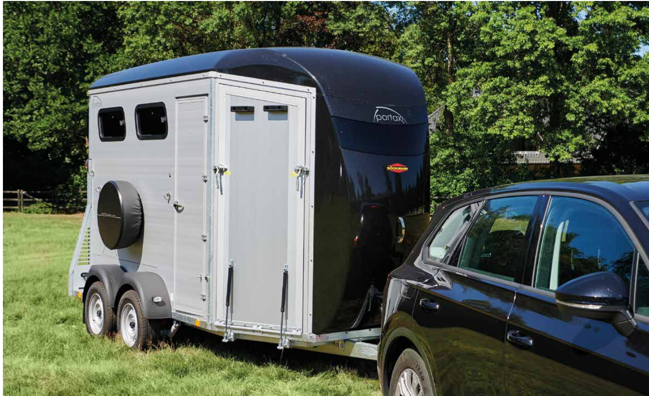
Licht te trekken dankzij de aerodynamische opbouw en het lage zwaartepunt - daardoor ook brandstofbesparend.
