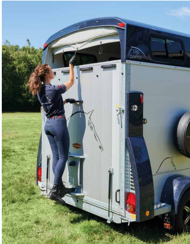
Eenvoudige bediening dankzij de praktische oprolfunctie van de zeillift. Hefinrichting voor het gemakkelijk openen van de achterklep, extra met stabiel opstapje met 2 treden.
