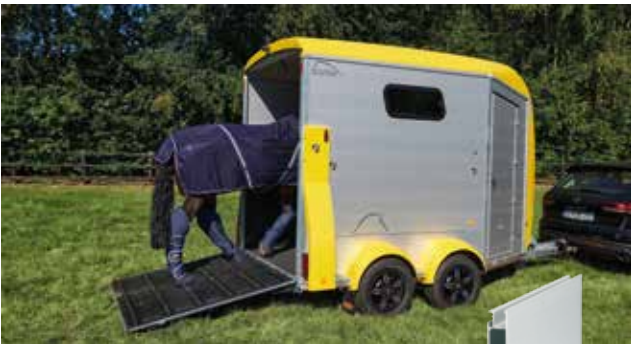
Geanodiseerd dubbel aluminium-vlonderprofiel voor een lange levensduur.
