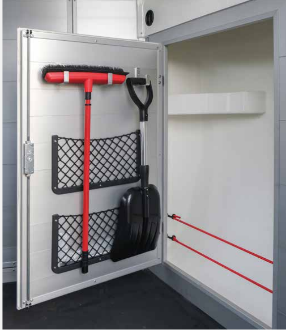
Boegkist als toebehoren verkrijgbaar in plaats van de standaard zadelkamer voor de Portax E en L E. De opbouw uit geanodiseerd aluminium met grote toegangsdeur sluit het paardengedeelte voor de massief polyester boeg veilig af en maakt het gebruik van de achterliggende binnenruimte mogelijk. Telescoopbezem, kunststof schep, zweefhouder en deurnetten maken deel uit van de serie-uitvoering.
