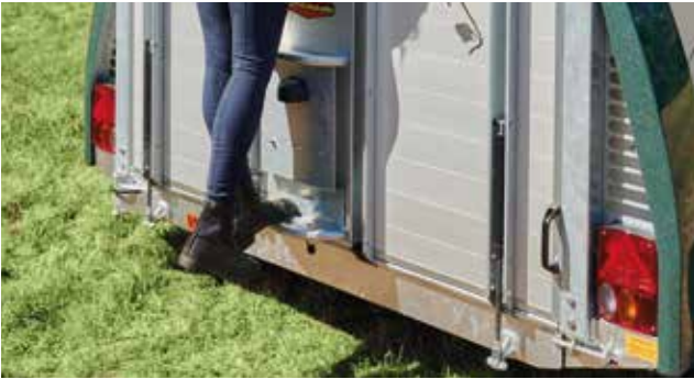
Stabiele achterklep door 4 thermisch verzinkte staalprofiel-zijsteunen met hefinrichting aan de binnenkant; extra met stabiel opstapje met 2 treden.
