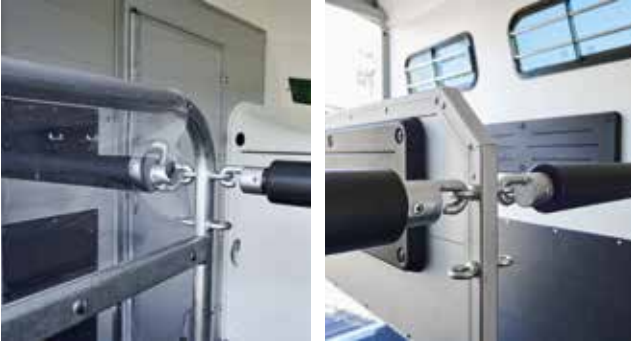
Stabiele tussenschotconstructie en hoogwaardige materialen door het massieve, gelaste aluminiumframe of het middenstijl-tussenschot uit geanodiseerd aluminium.
