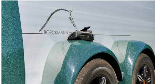
Spatscherm als legvlak dankzij de brede en aan de bovenzijde rechte vorm van het slagvaste spatscherm uit kunststof of polyester (toebehoren).
