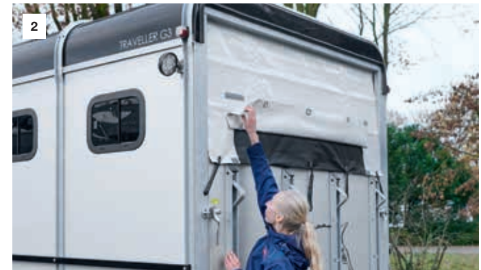
Zeillift met automatische oprolfunctie [1] en geïntegreerd net [2].
