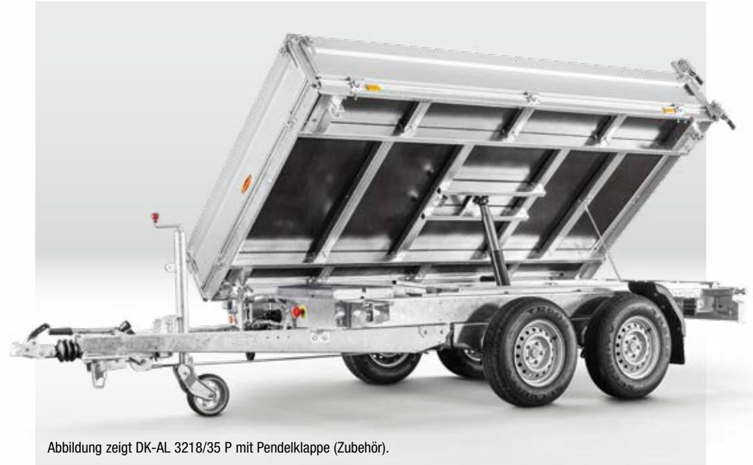
Abbildung zeigt DK-AL 3218/35 P mit Pendelklappe (Zubehör).
