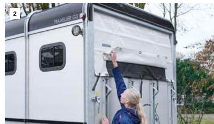
Planenlift mit automatischer Aufrollfunktion [1] und integriertem Netz [2].
