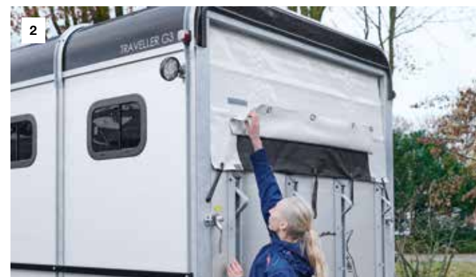
Planenlift mit automatischer Aufrollfunktion [1] und integriertem Netz [2].
