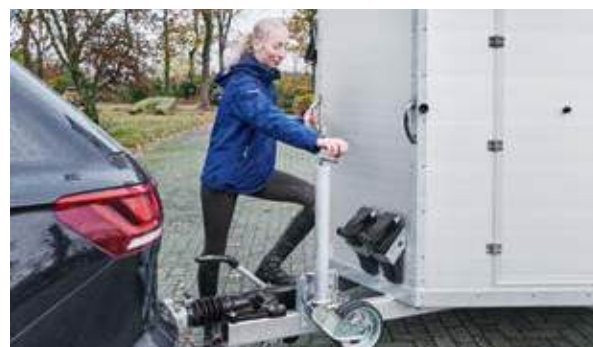
Einfache Bedienung durch das Schwerlast-Automatik-Stützrad (Serie beim K4 Big SK, K5, W3 Big SK, W4 und G3) oder durch das automatische Stützrad, extra lang mit handlicher Kunststoff-Kurbel, auch bei kaltem Wetter perfekt zu bedienen.
