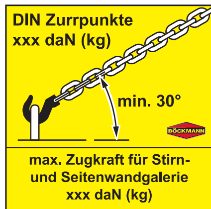
Fig. 5: Points d'arrimage sur la remorque Signale la capacité de charge des différents points d'arrimage sur la remorque.
