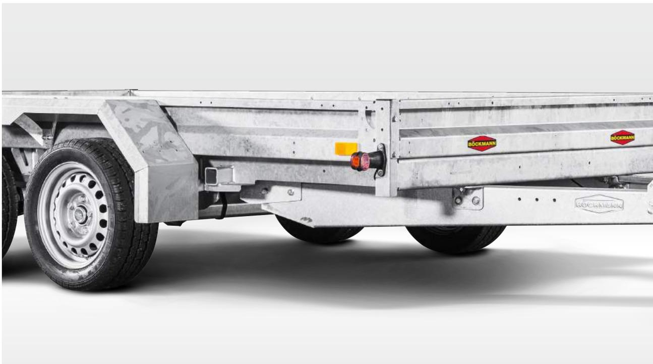
**Massive, feuerverzinkte Stahlkonstruktion mit Stahl-Längsträgern** und Stahlbordwänden (190 mm hoch).
