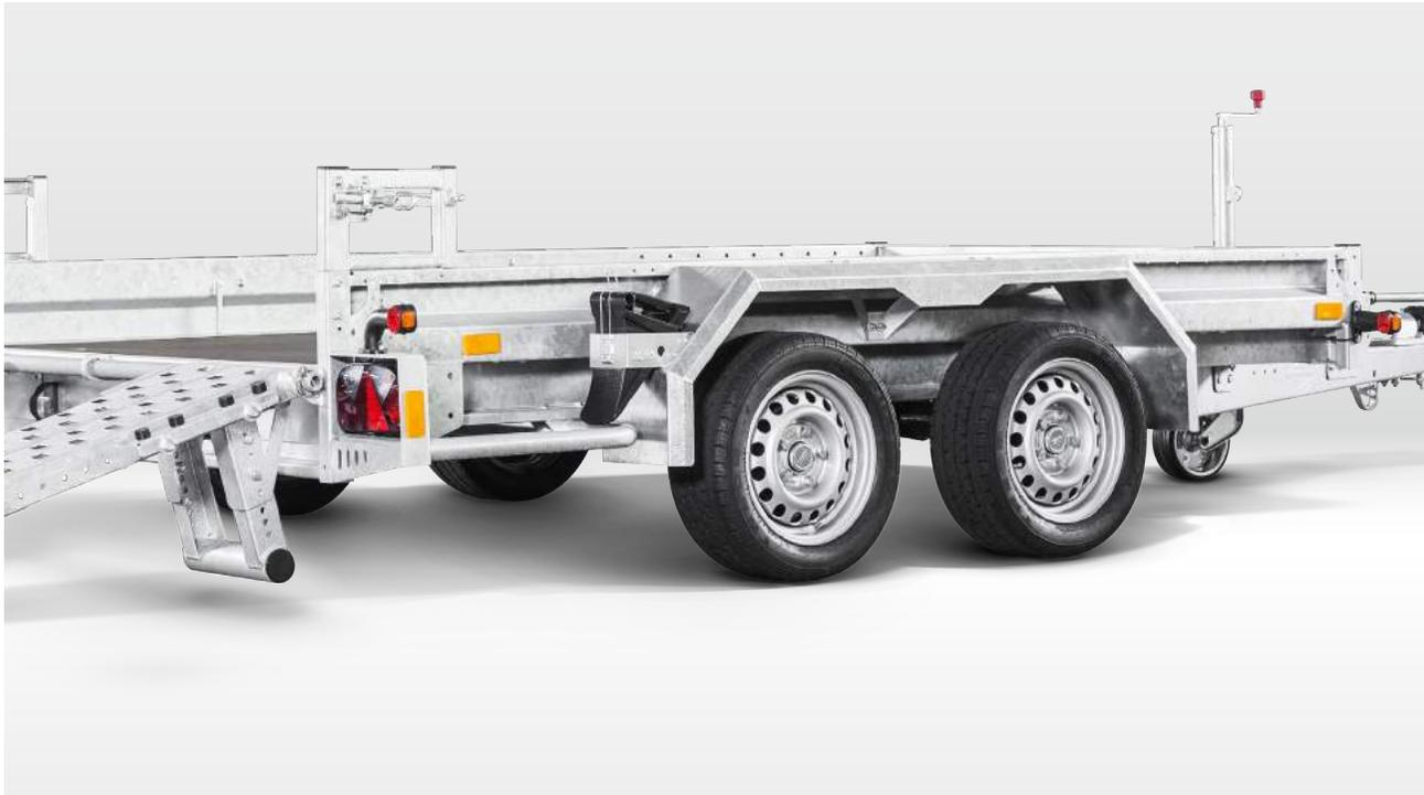
**Massive, feuerverzinkte Stahlkonstruktion mit Stahl-Längsträger** und Stahlbordwänden 190 mm hoch (BT-ST-Serie).
