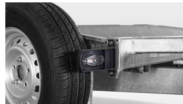
Optimal angebrachte LED-Umriss- und Begrenzungsleuchten um vom Zugfahrzeug aus die maximale Fahrzeugbreite im Blick behalten zu können. Optional Rückleuchte auch als LED-Beleuchtung erhältlich.
