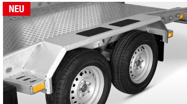
Radabdeckung mit Antirutschbeklebung Begehrbar und sehr stabil aus feuerverzinktem Stahl.
