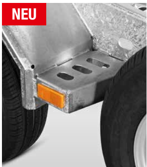
Trittstufen vor und hinter der Radabdeckung zum einfachen Ein- und Aussteigen.
