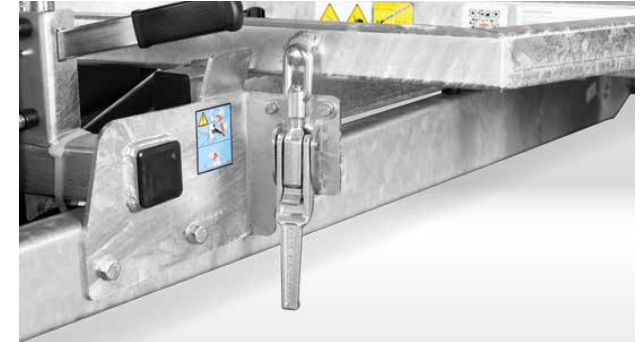
Klapperfreie Exzenterverschlüsse zum Sichern der Oberbrücke. Gut zugänglich durch die neue Positionierung vorne am Anhänger.
