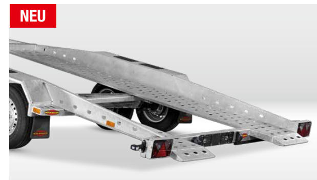
Klapperfreie Zurrbügel Mit vier Zurrbügeln zur Transportsicherung Ihrer Ladung. Alle Zurrbügel lassen sich mittels Feder in der Ladefläche versenken.
