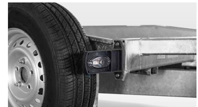
**Feux de gabarit et de position à LED idéalement positionnés**
