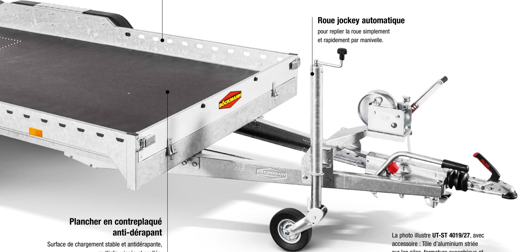
La photo illustre **UT-ST 4019/27**, avec accessoire : Tôle d'aluminium striée sur les ailes, fermeture excentrique et treuil avec support.
