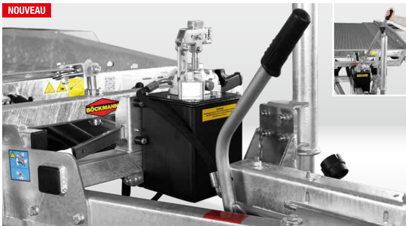
Fermetures excentrique sans claquement pour sécuriser le pont supérieur. Facilement accessibles grâce à la nouvelle position à l'avant de la remorque.
