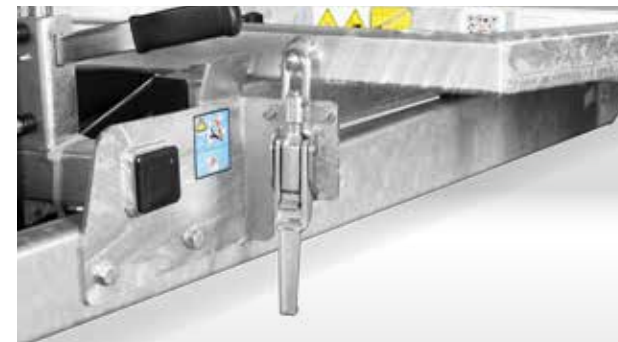
Fermetures excentrique sans claquement pour sécuriser le pont supérieur. Facilement accessibles grâce à la nouvelle position à l'avant de la remorque.
