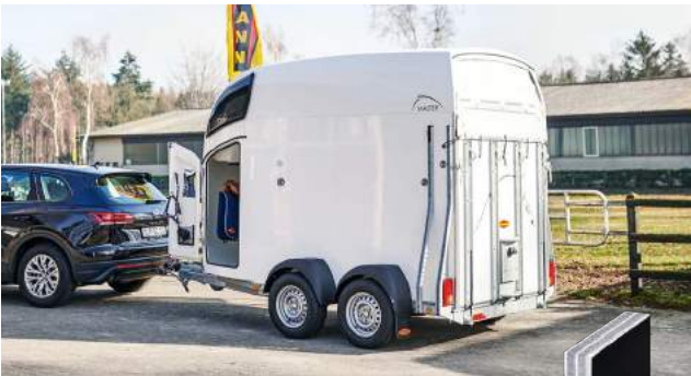
Houtvrije opbouw uit versterkt massief polyester voor een lange levensduur.
