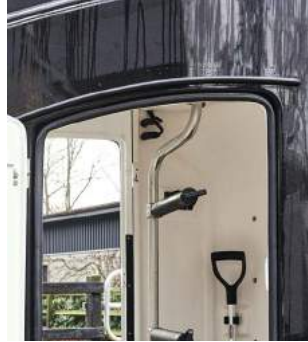
Bescherming tegen de regen dankzij de regenlijst boven de deuren en aan de achterkant.
