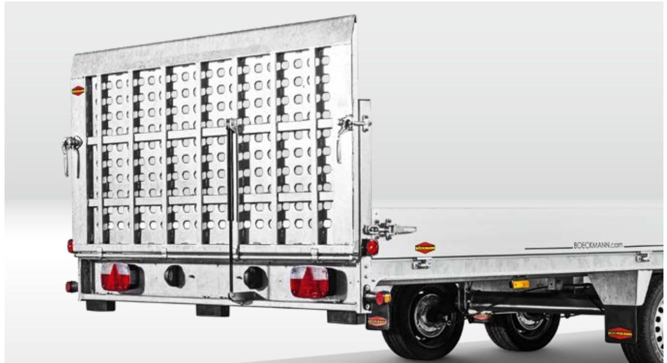
Robuuste oprijplaat uit massief geperforeerde staalplaat kan dankzij de gasveer eenvoudig worden neergelaten en opgetild. De 3-zijdig opklapbare en uithangbare aluminium zijborden maken van de MH-AL een universeel inzetbaar voertuig.
