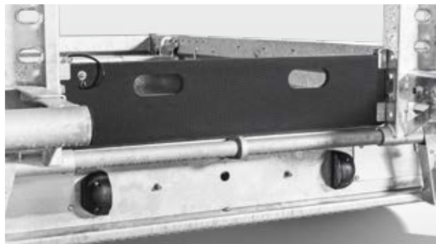
Steekplank voor de veilige vormafsluiting van de laadvloer (uitsluitend AS-modellen).
