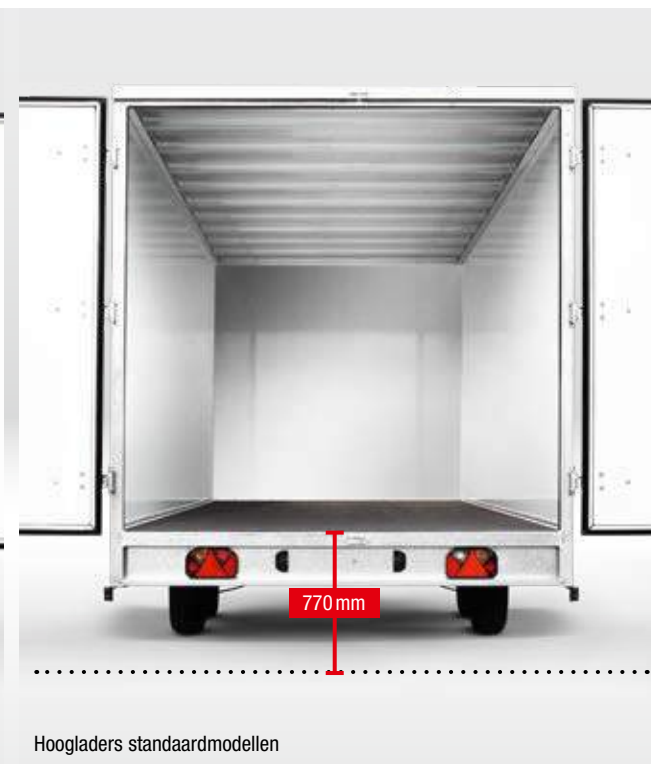
Laadhoogtes Om het laden en lossen van de gesloten aanhangwagens bijzonder gemakkelijk te maken hebben de F-modellen een lage laadhoogte vanaf 660 mm. Voor de standaardmodellen bedraagt deze tot 770 mm.
