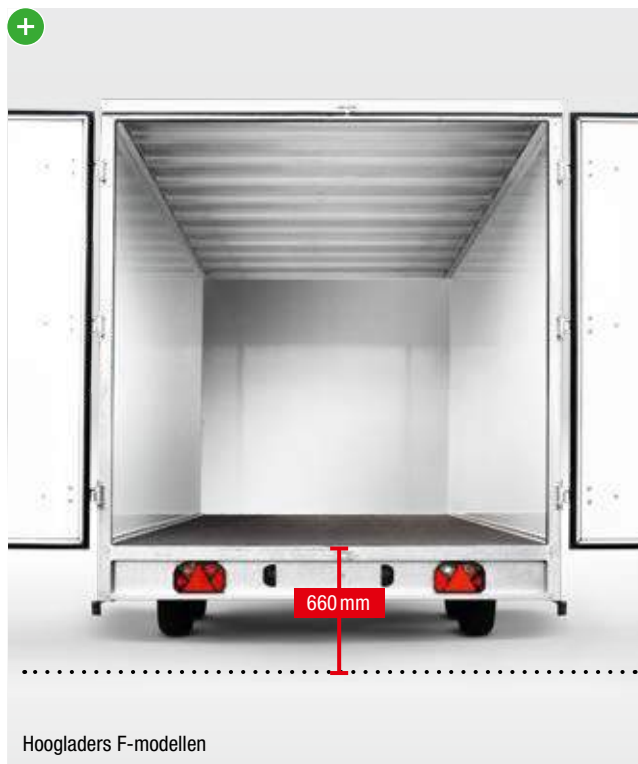
Laadhoogtes Om het laden en lossen van de gesloten aanhangwagens bijzonder gemakkelijk te maken hebben de F-modellen een lage laadhoogte vanaf 660 mm. Voor de standaardmodellen bedraagt deze tot 770 mm.
