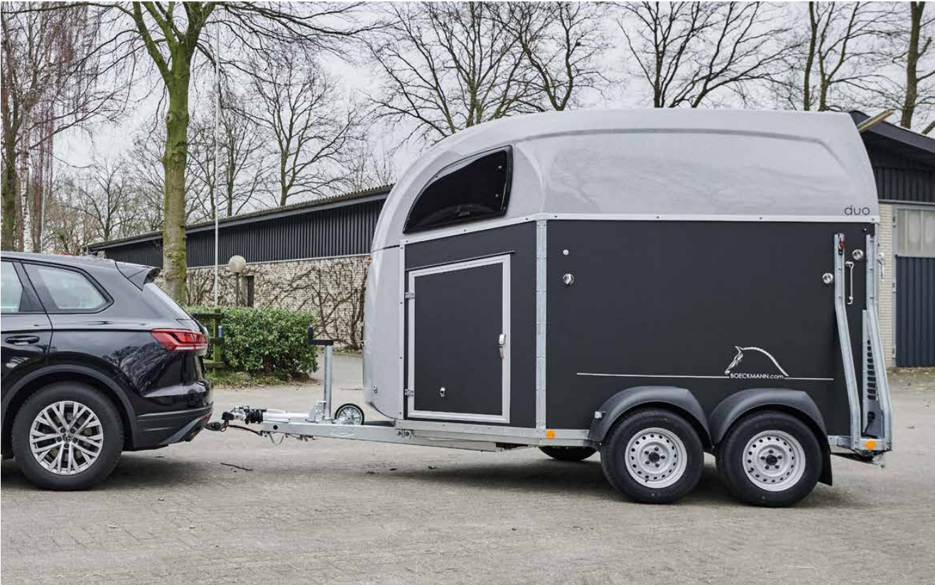
Leichtzügigkeit durch den aerodynamischen Aufbau und niedrigen Schwerpunkt.
