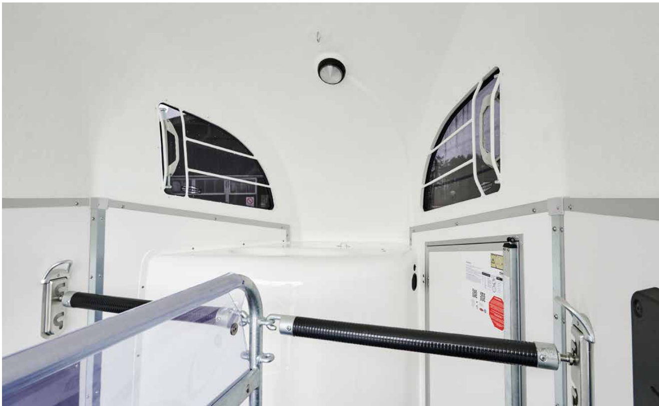
Viel Kopffreiheit, Platz und heller Innenraum durch die großzügigen Raumkonzepte der Uno und Duo Familie. Die getönten Aufstellfenster mit integriertem Gitter, große Räder ohne Ecken und Kanten und flache Scharniere bieten zusätzlichen Schutz.
