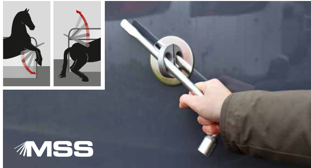
Schnelle Sicherheit im Notfall durch das bewährte Multi Safe Sicherheitsboxenstangen-Panik-System (MSS). Auslösbar vorne und hinten. Der Radschlüssel ist ein Teil der Serienausstattung.
