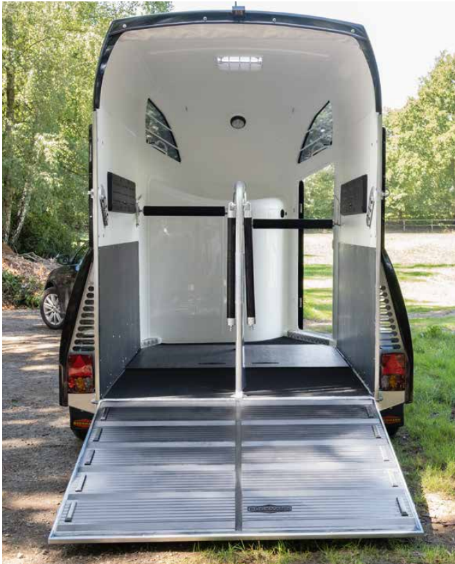
Viel Platz beim Be- und Entladen durch einen großen Abstand zwischen Boxenstange und Sattelkammer im vorderen Anhängerbereich.
