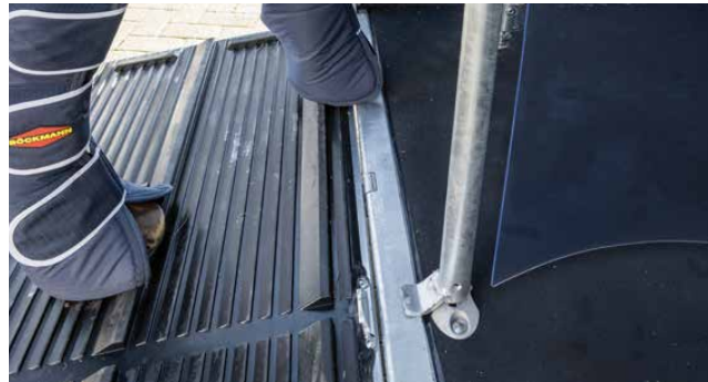
Optimaler Halt und minimierte Rutschgefahr durch Spezial-Quertrittleisten, Seitenstopps auf dem Hinterklappenbelag und das geschlossene, schmale Hinterklappenscharnier.
