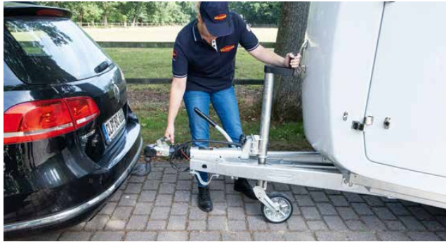
Bequemes Rangieren durch das automatische Stützrad, extra lang mit handlicher Kurbel und optimal platziertem Rangiergriff, auch bei kaltem Wetter perfekt zu bedienen.
