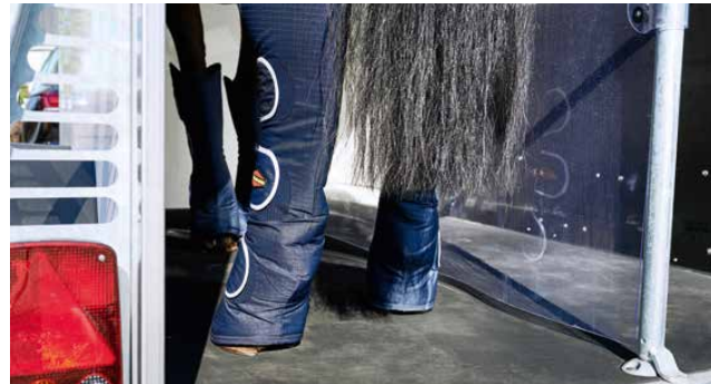
Bequeme Breitstellung durch die Befestigung des PVC-Behangs erst ab 600mm über dem Boden – für eine angenehme Fahrt.
