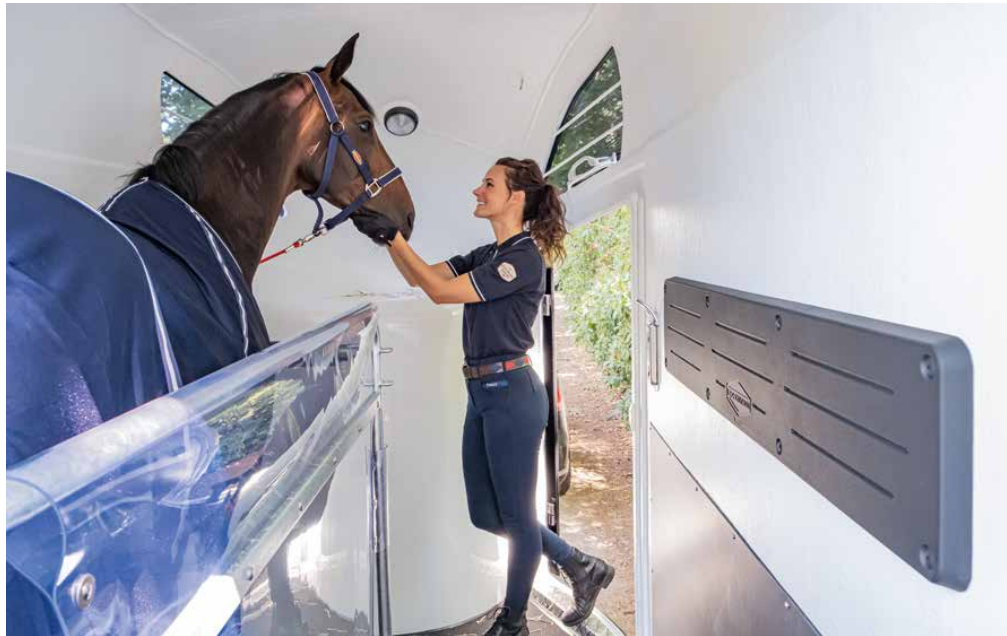
Sicherer Transport durch das bewährte Böckmann Trennwand-System und das bis zu 10cm höhenverstellbare Sicherheitsboxenstangensystem (MSS) mit Anbinderingen. Weiteren Schutz bieten die Boxenstangen-Zusatzpolsterung sowie die Polsterung und der Trittschutz an den Seitenwänden (letzteres ist Zubehör).
