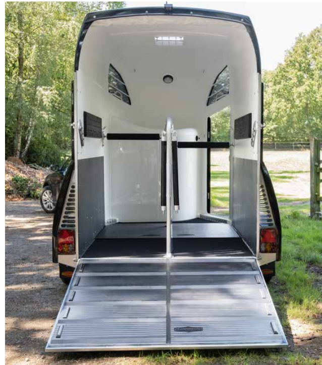
Großer und einladender Durchgang durch schmale Haubenkanten, innenliegendem Planenlift und die hellen, weißen Innenwände. Bei Nacht sorgt die Innenbeleuchtung für ausreichend Licht im Innenraum.
