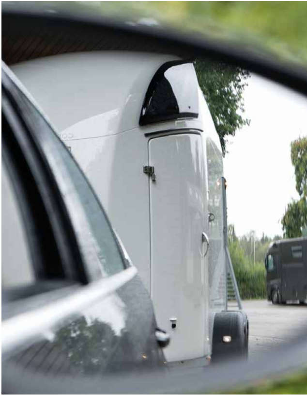
Gute Sicht während der Fahrt durch geschlossene, spezialgelochte Heckstreben.
