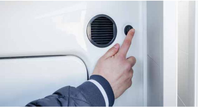
Komfortable Bedienung durch den gut erreichbaren und separaten Lichtschalter für die Innenbeleuchtung an der rechten Einstiegstür.
