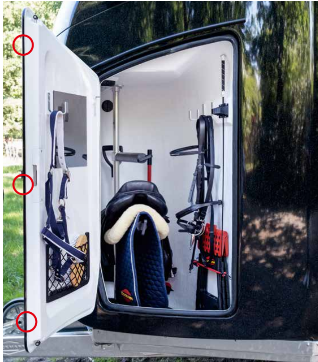
Optimales Verschießen durch die 3-Punkt-Türverriegelung und die Gummidichtung.
