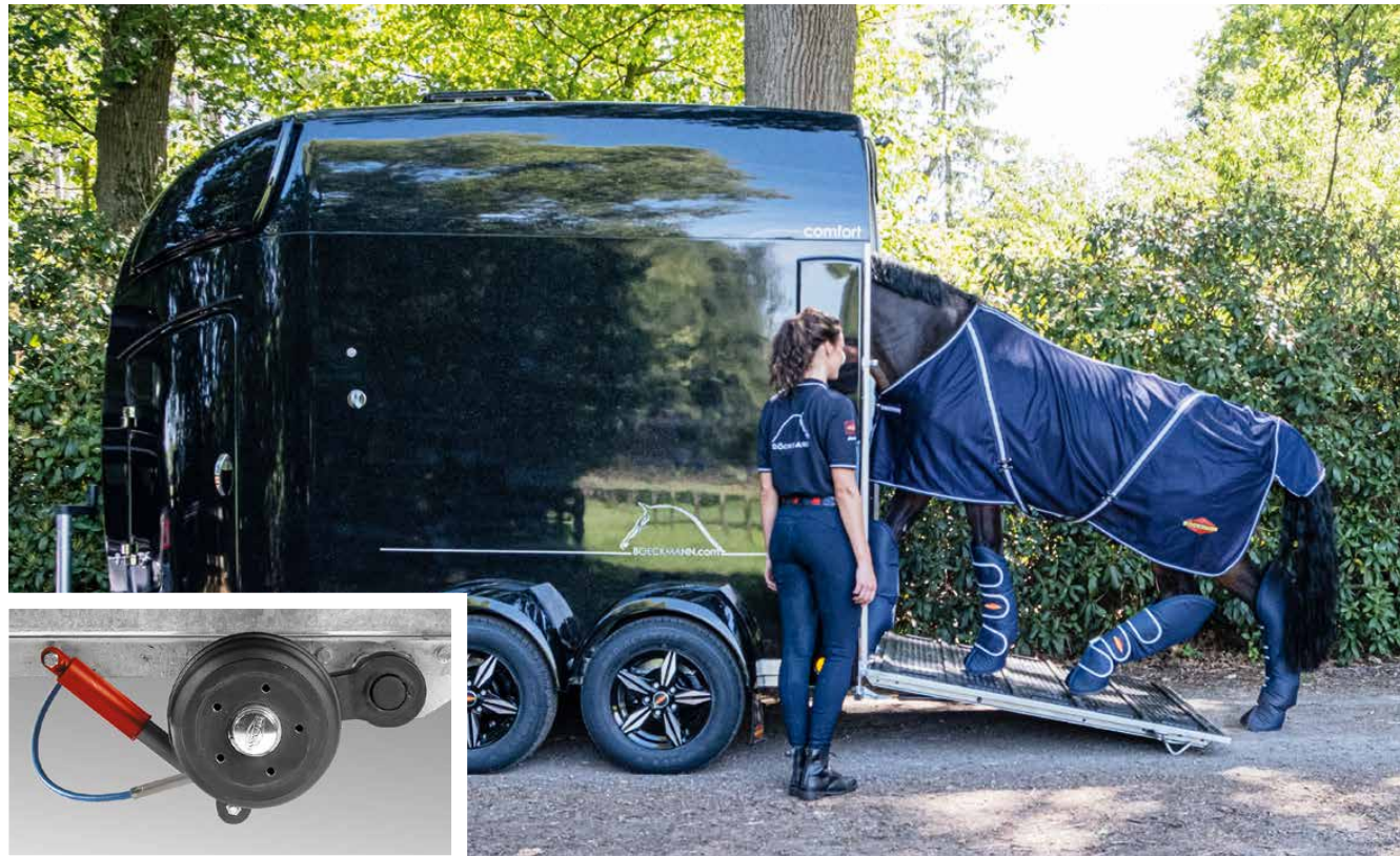
Niedrige Verladehöhe durch das tiefergelegte Comfort-Federungs-Fahrgestell „CFFplus“ mit Radstoßdämpfern und weicher Federung.
