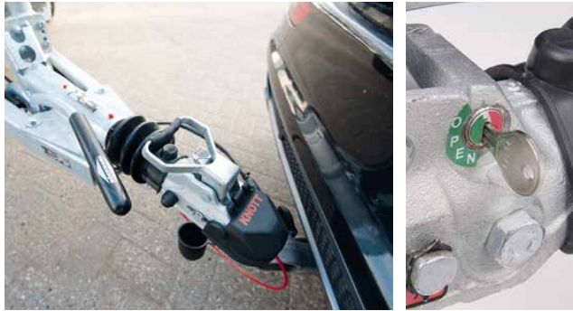
Anfahr- und Diebstahlschutz durch die abschließbare Gusskupplung mit Soft-Top Anfahrerschutz und dem gummierten, komfortablen Herzgriff.
