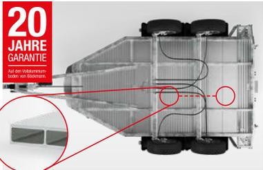
**Robust und unverrottbar** durch den massiven Qualitäts-Vollaluminiumboden mit geschlossenem Profil zur Verstärkung im Pferdestandbereich.
