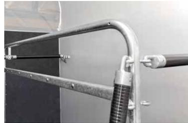
**Sicherer Transport** durch die bewährte Böckmann Trennwand und das vorne um 15 cm höhenverstellbare Sicherheitsboxenstangensystem mit Anbinderingen.
