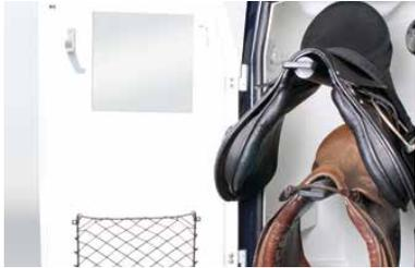
**Viel Platz für Reitutensilien und Zubehör** durch die Sattelkammer mit Futtertrog, Kunststoffschaufel, Türnetz, Spiegel an Tür und ausziehbaren Sattelhalter, vertikal/horizontal verstellbar.
