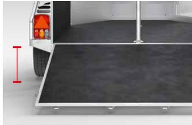
**Einfacher Einstieg** durch das tiefergelegte Fahrgestell und mehr Sicherheit durch die verstärkte Hinterklappe mit rutschfestem, 8mm starkem Gummi.
