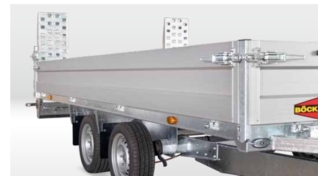
Ridelles 350 mm (seulement MH-AL série) Les ridelles élevées offrent une plus grande hauteur de chargement à l'intérieur de la remorque.
