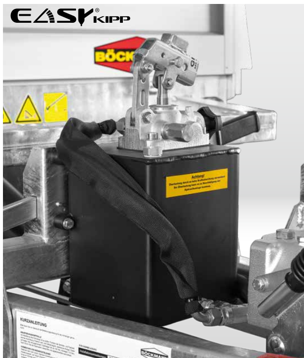
Système hydraulique EasyKipp (seulement MH-AL série) pour basculer le plateau supérieur à l'aide d'une visseuse sans fil.
