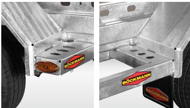
Marche-pieds avant et arrière de la protection de roue pour faciliter la montée et la descente.
