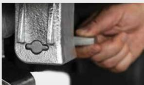
**Vertauschungssichere Steckbolzen** Das falsche Stecken der Bolzen und das Schiefziehen der Brücke ist ausgeschlossen.
