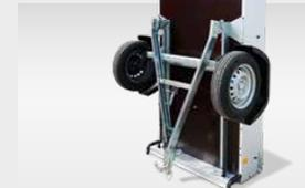
**Platzsparende Lagerung** durch Abklappen der V-Deichsel.
