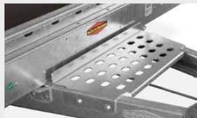
**Schaufelablage** zur sicheren Platzierung der Schaufel während des Transports.
