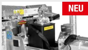
**Hydraulisches Hebesystem mit Handpumpe** ermöglicht ein leichtes Kippen des Anhängers.
