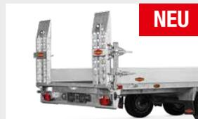
**Kurze Auffahrschienen** in der Breite verstellbar für eine gute Sicht nach hinten und einen geringen Luftwiderstand.
