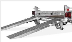
**Niedriger Auffahrwinkel** dank den langen Auffahrschienen und einer Ladehöhe von ca. 450 mm.
