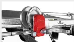
**Windenbock mit Seilwinde und Umlenkrolle** für ein bequemes sowie sicheres Be- und Entladen.
