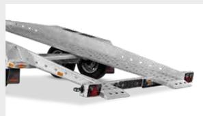
**Auffahrwinkel von 13°** für ein leichtes Be- und Entladen.
