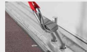
**Versenkte Zurrbügel** zur Sicherung der Fahrzeuge während des Transports.
