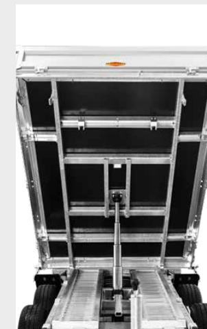
**Schienenablage in der Unterbrücke** ermöglicht durch das Nachrüsten von Schienenwinkelprofilen (Zubehör) einen einfachen und sicheren Transport von Auffahrschienen (Zubehör).
